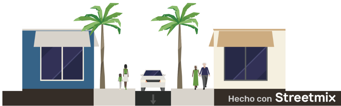
Ilustración 14. Sección vial local con servidumbre de 6.0 metros
