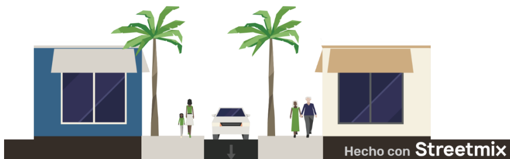
Ilustración 13. Sección vial colectora con servidumbre de 6.0 metros
